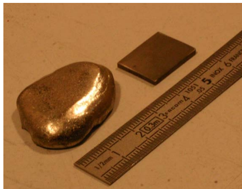
Figure 73. Bouton de titane nitruré élaboré au four à arc (à gauche) et plaquette obtenue par électroérosion (à droite).
