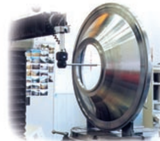
⑦ Disque de turbine BP étage 5 - inonel 718 LPT DISC St. 5
