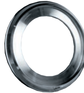
② Disque de turbine BP étage 8 - Waspaloy Gat. LPT DISC St. 8
