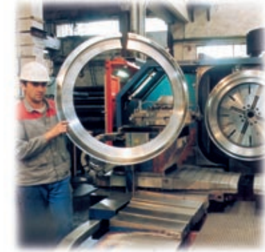
④ Disque de turbine BP étage 6 - Waspaloy Gat. LPT DISC St. 6
