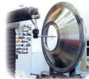
⑦ Disque de turbine BP étage 5 - inonel 718 LPT DISC St. 5
