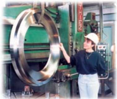
① Disque de turbine BP étage 9 - inonel 718 LPT DISC St. 9
