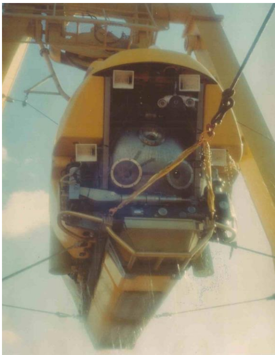
Nautil - Vue générale et sphère en TA6V ( \varnothing=2,1 m)
