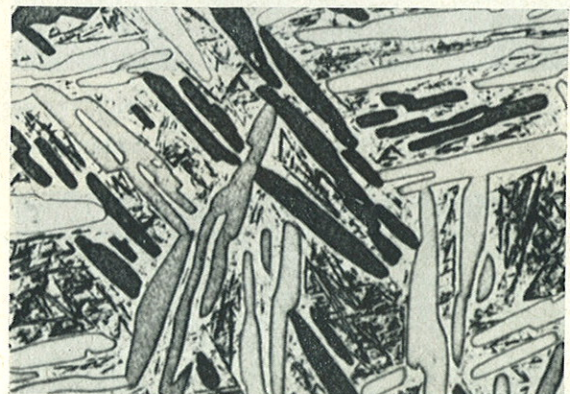
Fig. 44. — Trempe isotherme \searrow 900 °C 4 h (eau). Précipitation \alpha_2 sur fond \alpha'_1 + \alpha'_2 . \times 1000 .
