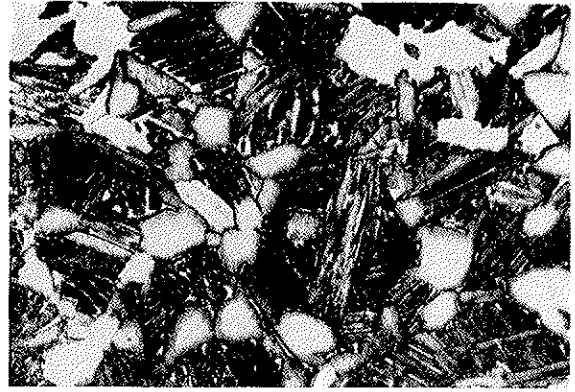
Fig. 32. — Cycle de recuit arrêté à l'air à 950 °C \alpha_1 + (\alpha + \beta) . \times 1000 .
