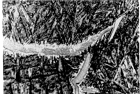
Fig. 38. — Trempe isotherme \searrow 950 °C 30 s (eau). Précipitation \alpha_2 inter- et intragranulaire. \times 1 000.
