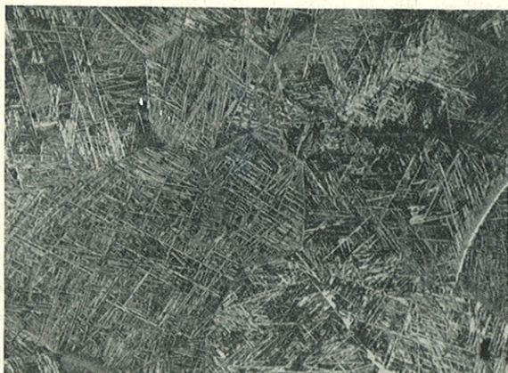
Fig. 52. — Trempe isotherme 1 025 °C 30 mn \searrow 600 °C 15 s (eau). Structure martensitique \alpha' . \times 500. (Réduit de 2/7 à la reproduction.)
