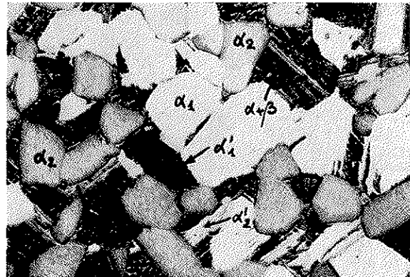
Fig. 33. — Cycle de recuit arrêté à l'air à 900 °C [ \alpha_1 + \alpha_2 + \alpha'_1 + \alpha'_2 + (\alpha + \beta) ]. \times 1000 .
