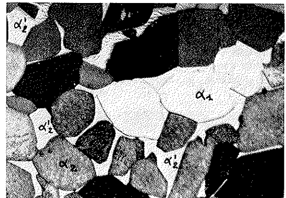
Fig. 14. — Cycle de recuit arrêté à l'eau à 750 °C.
