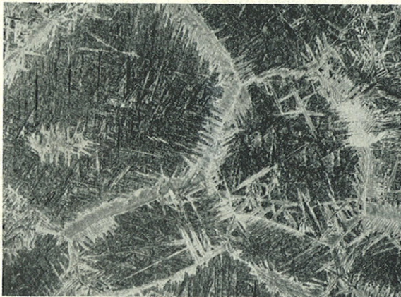
Fig. 47. — Trempe isotherme \searrow 800 °C 15 s (eau). Précipitation \alpha intergranulaire sur fond \alpha'_1 . \times 500 . (Réduit de 2/7 à la reproduction.)
