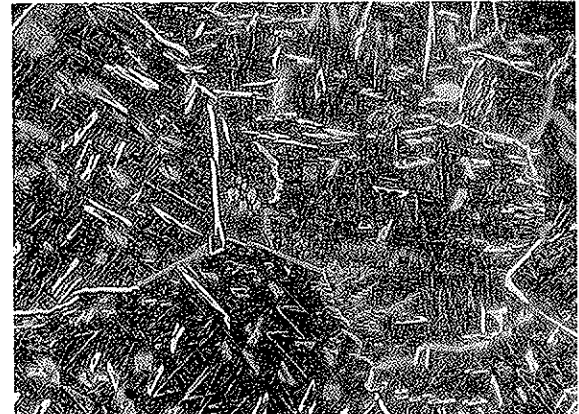
Fig. 39. — Trempe isotherme 1 025 °C 30 mn \searrow 950 °C 5 mn (eau). Précipitation \alpha_1 et \alpha_2 inter- et intragranulaire. \times 500. (Réduit de 2/7 à la reproduction.)
