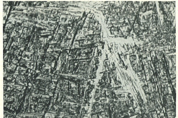
Fig. 49. — Trempe isotherme \searrow 750 °C 15 s (eau). Précipitation \alpha_1 intergranulaire. \times 1000 .
