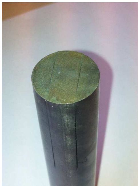
Contraintes résiduelles détectées à réception après coupe par électro érosion
