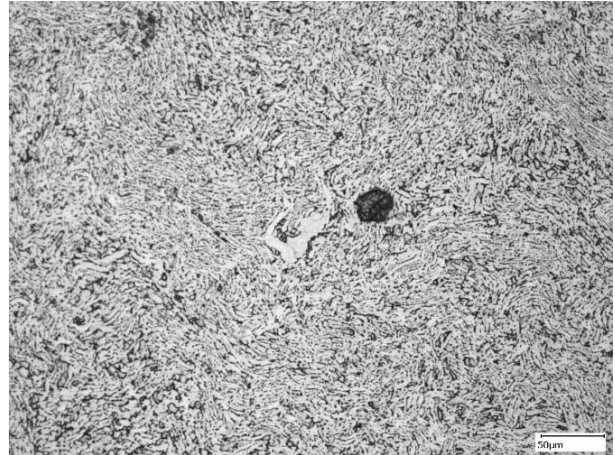
Cliché 14 – ETTC2 : base A4 La présence de nodules alpha trop important est non conforme : ce cliché est OK si isolé
