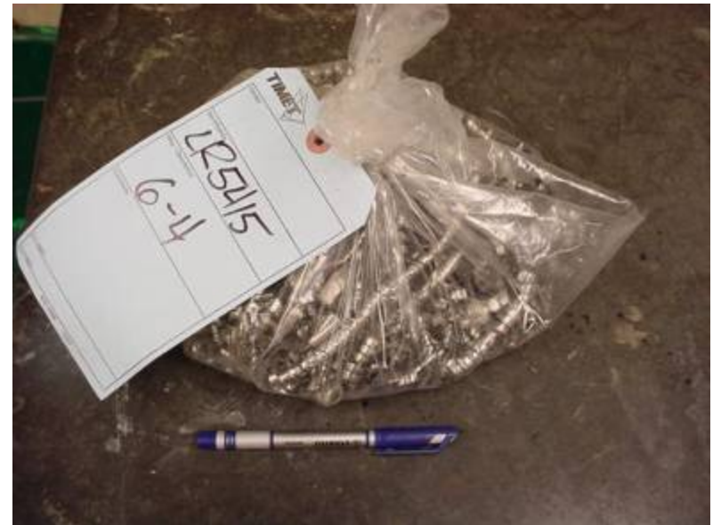
Échantillon de 2 kg pour identifier le niveau de contamination
