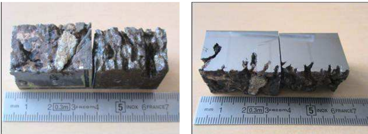
Aspect des peaux des produits avant (échantillon gauche des photos) et après grenailage (échantillon droite des photos).
