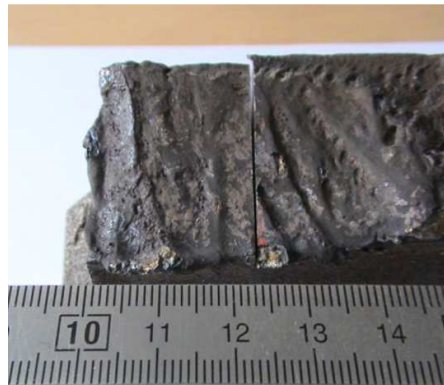
Aspect de la découpe plasma avec coulures en bordure de coupe (bas de l'échantillon)
