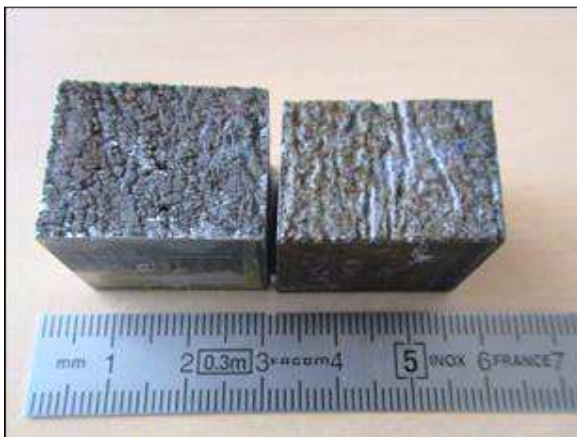
Aspect des peaux des produits avant (échantillon gauche des photos) et après grenailage (échantillon droite des photos).
