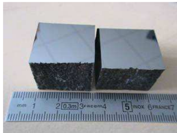
Aspect des peaux des produits avant (échantillon gauche des photos) et après grenailage (échantillon droite des photos).
