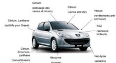
Figure 3 : Nature des terres rares et leur localisation dans les véhicules hybrides
