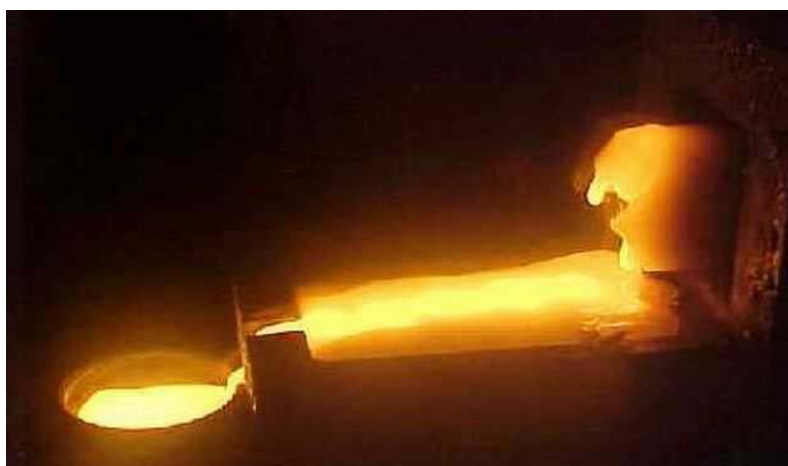
Photo du creuset froid avec déversement de métal dans la lingotière
