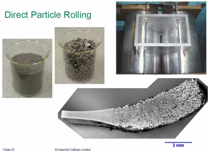
Figure 22: Technique de laminage directe de poudre Armstrong (source : Imperial College)
