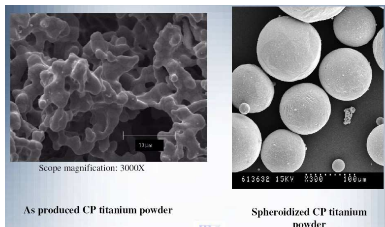
Figure 21: Morphologie des poudres Armstrong à l'état brut et après sphéroïdisation (source : ITP)
