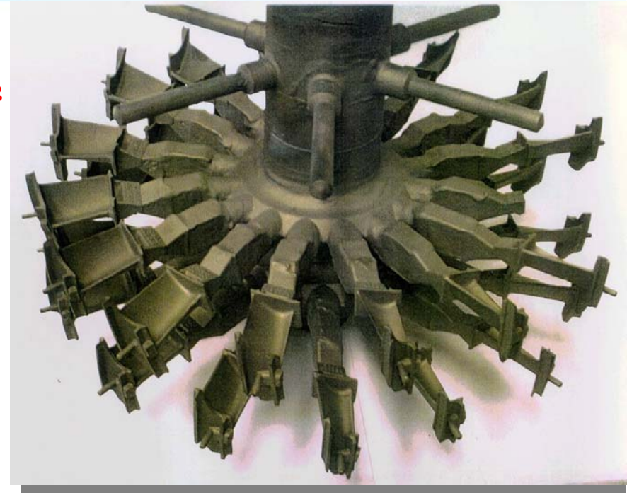
Aubes Turboméca moulées par la société TARMM
