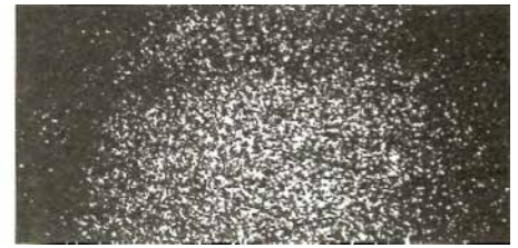
Figure 5 – Précipités de phase \omega isotherme dans l'alliage \beta -CEZ
