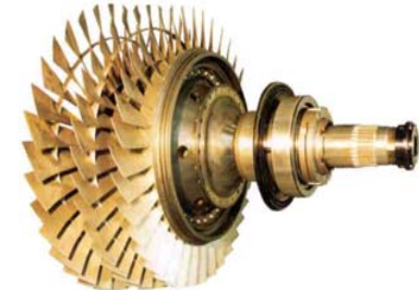
COMPRESSEUR BASSE PRESSION CFM56 TA6V PQ et Ti17
